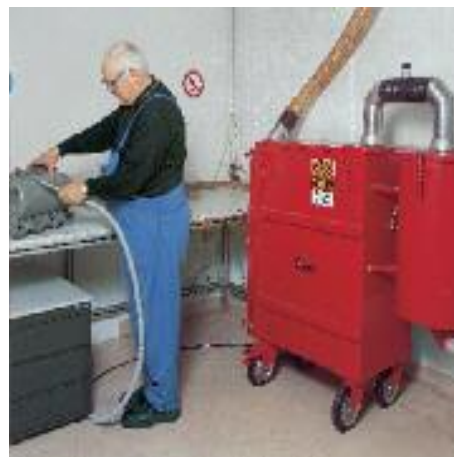
NA 250 Stahlblech mit Reststaubfilter in der Automobil- zulieferproduktion
