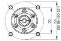
Bohrbild für Antriebsaufbau Hole pattern for actuator mounting
