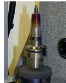
Schrumpffutter auf den Pin setzen
