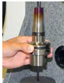
Länge bis zum Anschlag der Werkzeugschneide bestimmen
