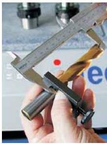
Festlegen der Auskraglänge des Schneidwerkzeugs
