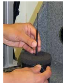
Länge des Pins der Austreibeinrichtung einstellen (bis Anschlag + ca. 2 cm)
