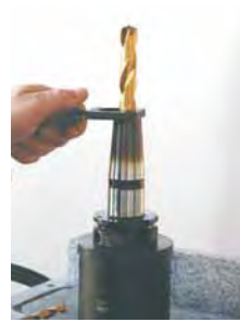
Schneidwerkzeug bis zum Anschlag einsetzen
