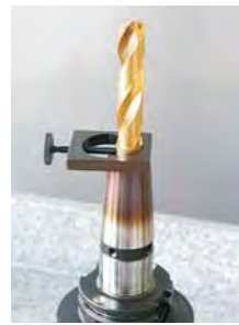
Schrumpffutter abkühlen lassen
