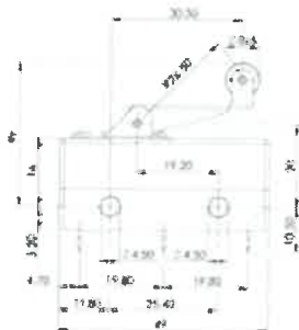
Type 6AL : Einfacher Hebel mit Kipprolle - Indirekt betätigt -
